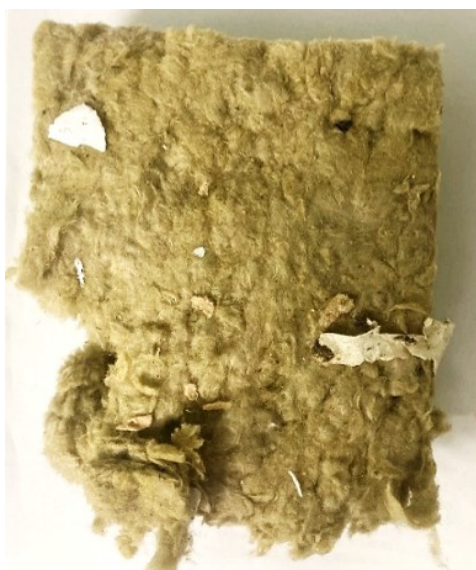
Рис. 7. Повреждения, нанесённые звукоизоляционному материалу при групповом содержании домовыми мышами (а) и серыми крысами (б).
