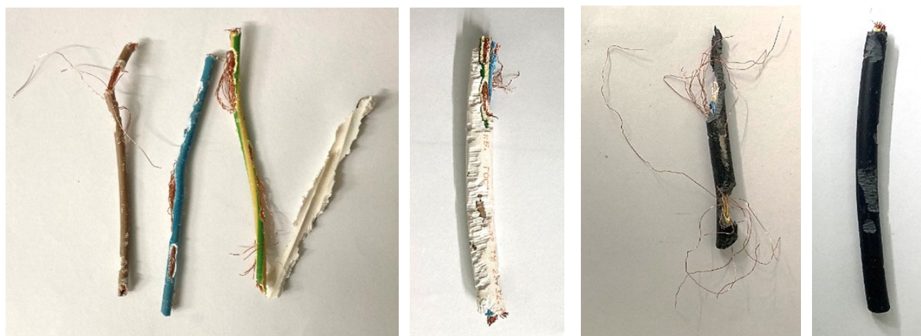
Рис. 9. Сравнение повреждений образцов кабеля типа ПВС (белого цвета) и кабеля типа КГТП (чёрного цвета) при одиночном содержании серых крыс
