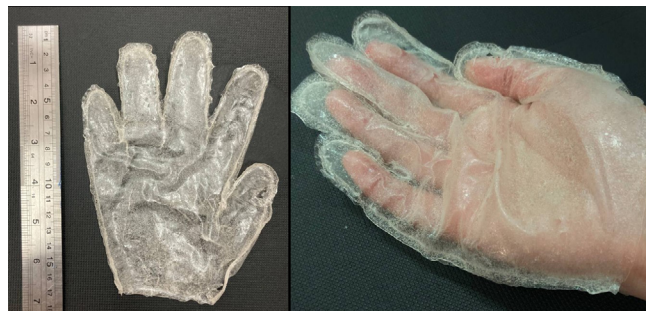
Рис. 4. Образцы перчаток с антимикробными свойствами, полученные с помощью 3D-печати.
